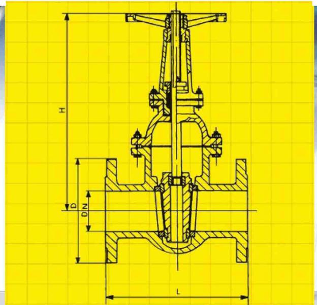
Le valvole a saracinesca a corpo cilindrico vite esterna in acciaio sono utilizzate in svariate tipologie di impianti, tipicamente in impianti industriali con liquidi pericolosi o ad alte temperature, per pressioni fino a 63 bar. Le valvole a saracinesca a corpo ovale vite esterna sono in acciaio, con gli anelli di tenuta del corpo e del cuneo in acciaio inox. In esecuzione standard con volantino.
