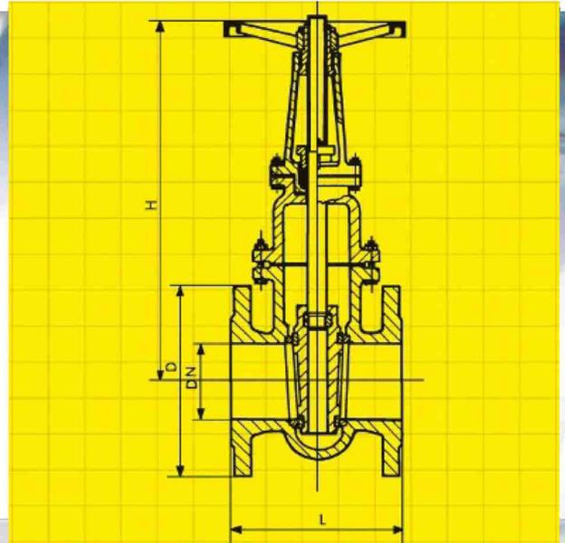
Le valvole a saracinesca a corpo piatto vite esterna in acciaio sono utilizzate in svariate tipologie di impianti, tipicamente in impianti industriali con liquidi pericolosi o ad alte temperature, per pressioni fino a 16 bar. Le valvole a saracinesca a corpo ovale vite esterna sono in acciaio, con gli anelli di tenuta del corpo e del cuneo in acciaio inox. In esecuzione standard con volantino.
